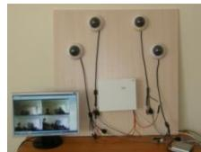
Стенд предназначен для проведения лабораторных и практических работ по курсу «Компьютерные сети и телекоммуникации» в средних специальных учебных заведениях, обучающихся по направлению 09.02.01 Компьютерные системы и комплексы, 09.02.03 Программирование в компьютерных сетях, а так же всем, кто интересуется современными технологиями и принципом построения систем видеонаблюдения.
