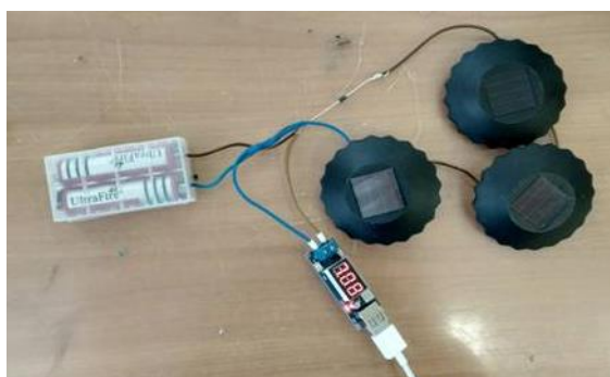
Рис. 1. Вторая модель с фотоэлементами из садовых фонариков и с 2 аккумуляторами (вырабатывала примерно 7 В)
